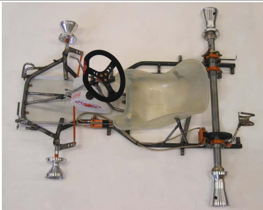
PHOTO VUE DE DESSUS DU CHÂSSIS COMPLET IDENTIQUE À L'UN DES MODÈLES PRÉSENTÉS À L'HOMOLOGATION SANS PARE-CHOCS, CARROSSERIE NI PNEUMATIQUES
